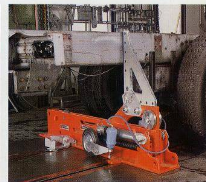
■SR-1 40TONプレストロリー 固定時の図です。
