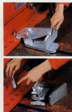
プレストロリーはJ012で床のレールに固定されます。
