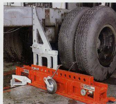
■SR-2 40TONプレストロリー 固定時の図です。
